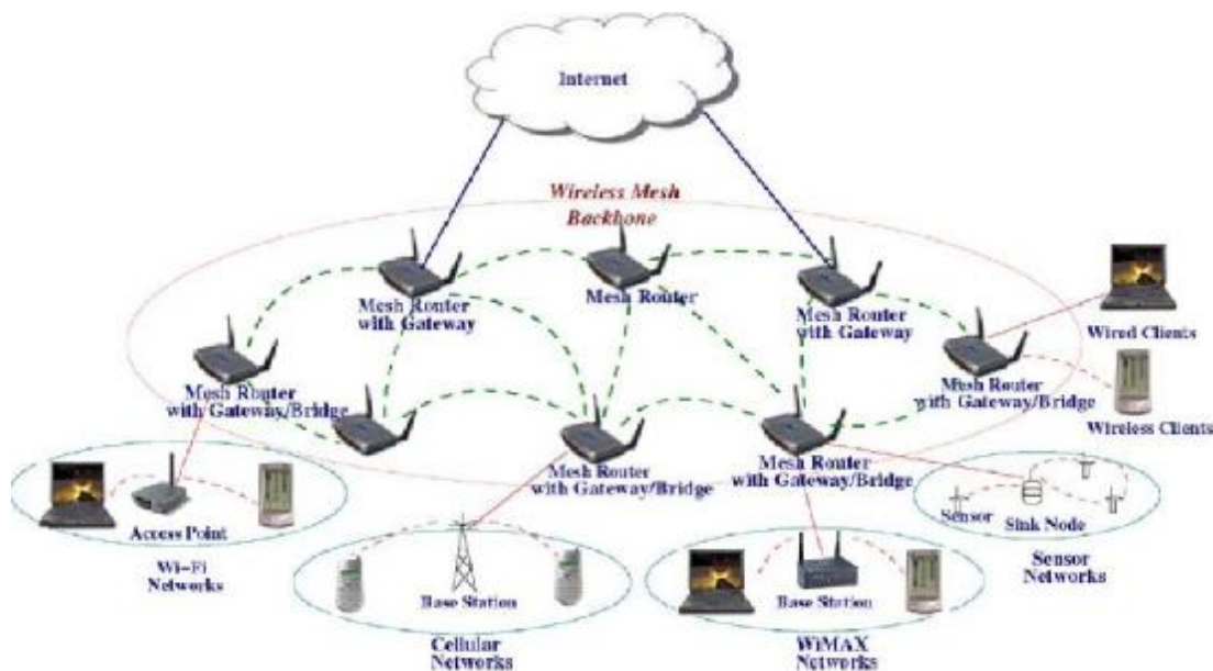
圖1、無線網狀網路的架構
